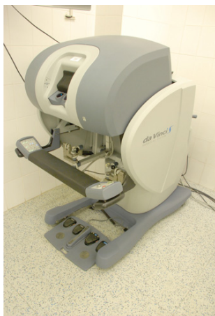
Рис. 10. Консоль хирурга роботической системы da Vinci
